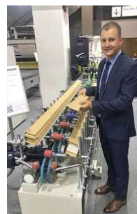
Optaszczowarka profili PW 35 F6-VMM z systemem podawania termotopliwego kleju PUR/EVA/PO służy do oklejania profili MDF, drewnianych, paneli ściennych, ramek i ościeżnic naturalnym fornirem, folią finish, PP, PVC i CPL.
