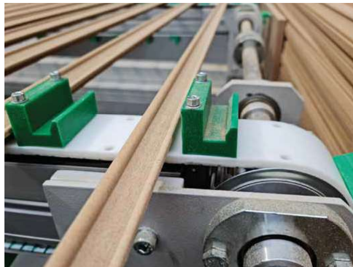
Optaszczowarka profili PW 35 F6-VMM z systemem podawania termotopliwego kleju PUR/EVA/PO służy do oklejania profili MDF, drewnianych, paneli ściennych, ramek i ościeżnic naturalnym fornirem, folią finish, PP, PVC i CPL.
