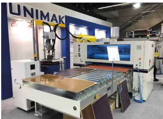
Linia do płaskiej laminacji FL1 1400 PUR –nanoszenie termoplastycznego kleju poliuretanowego (PUR) odbywa się za pomocą walców na płyty, a okleina jest podawana z rolki lub - w przypadku arkuszy - ze specjalnie przygotowanej rampy. Fot. Unimak
