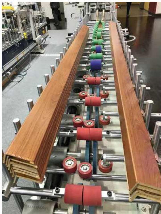
Opłaszczarka profili PW 35 P6-PA cechuje szerokie zastosowanie w procesie oklejania listew drewnianych, MDF, ramek oraz kątowników o szerokości od 20 do 350 mm i maksymalnej wysokości 125 mm. Firma Unimak oferuje szeroki zakres opłaszczarek do różnego rodzaju produkcji. Fot. Unimak
